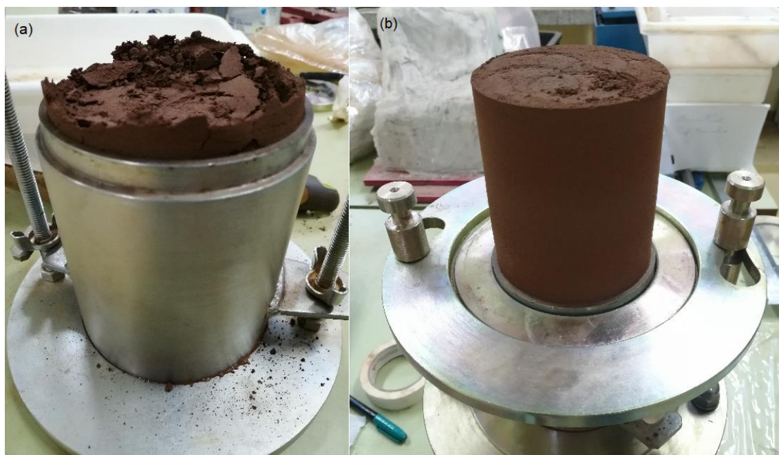
Figura 13. Ensaio de compactação Proctor. (a) Amostra compactada com energia de compactação de 9,91 kg.cm/cm³, (b) retirada da amostra compactada do molde cilíndrico.
