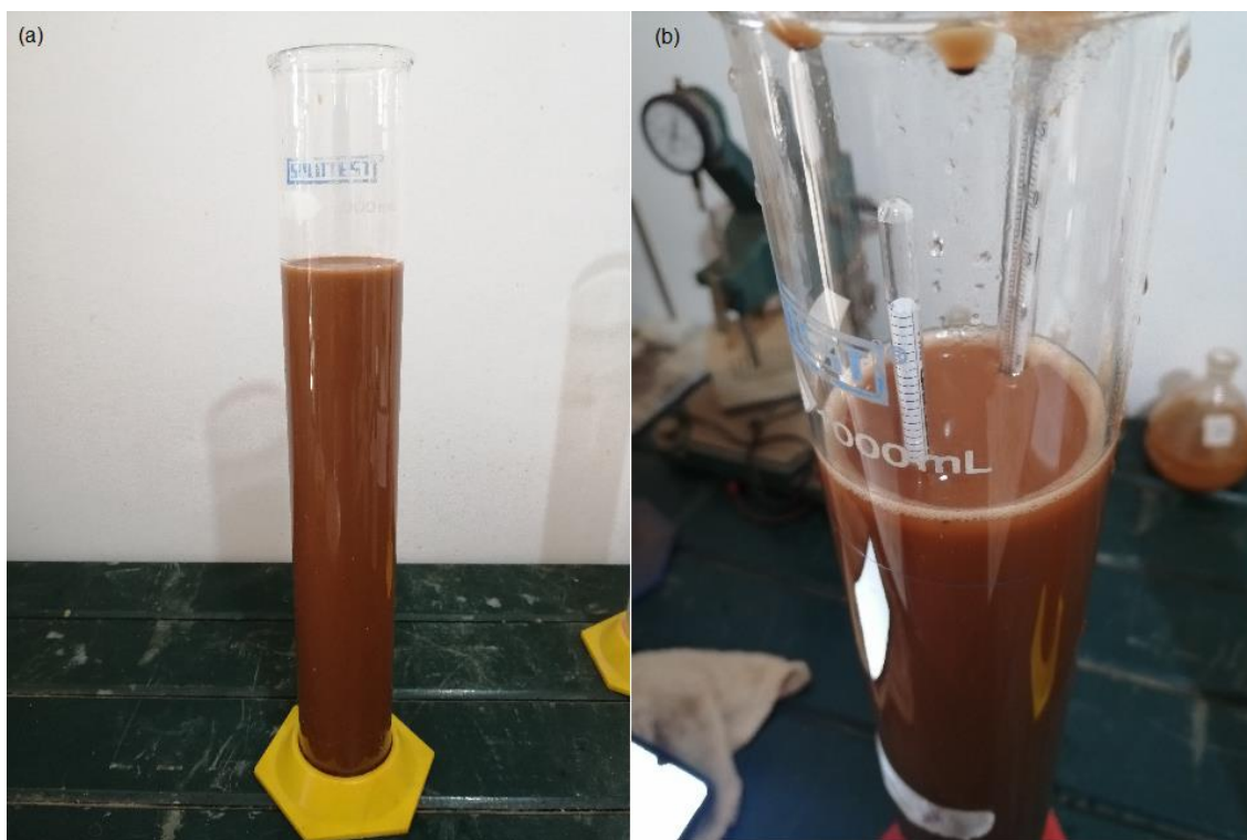
Figura 10. Ensaio de análise granulometria por meio da sedimentação. (a) amostra de rejeito disperso em água destilada em repouso para sedimentar. (b) Leituras de temperatura e do densímetro imerso na proveta.
