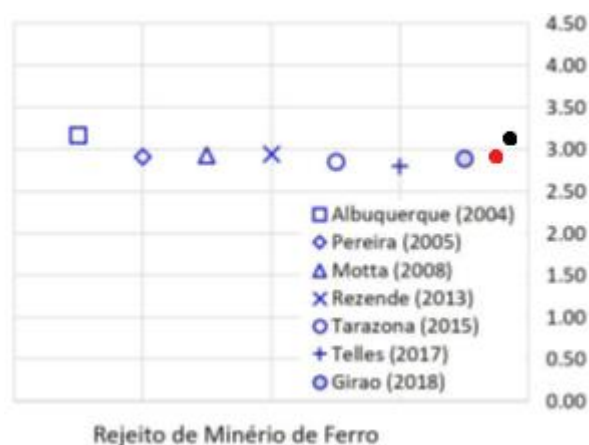
Figura 199. Densidade dos grãos de rejeito de minério de ferro estudados anteriormente e densidade dos grãos determinados pelo Lab. A, em vermelho, e Lab B, em preto. Fonte: Modificado de Sotomayor, 2018.
