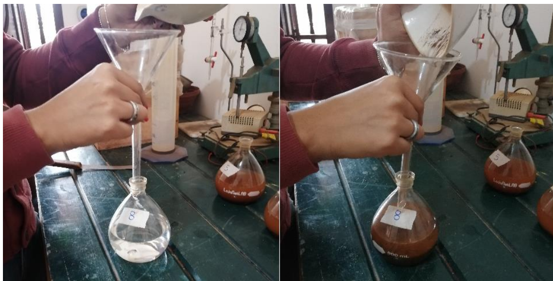
Figura 11. Execução do ensaio de densidade dos grãos, com transferência da amostra para o picnômetro com auxílio do funil de vidro.
